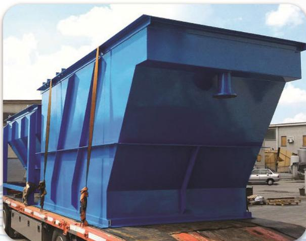
این دستگاه از ورق فولادی 37 st با دو لایه اپوکسی از داخل و خارج تولید می شود.
